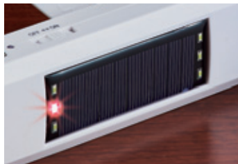
ブザーと同時に赤色 LED 1 個点滅
